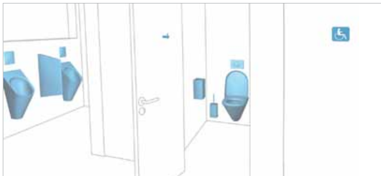
WC-KABINE/URINAL-RAUM: Urinale, Urinaltrennwand, Urinalspülarmaturen, Kleiderhaken, WC-Rollenhalter, WC-Bürste und Bürstenhalter, WC mit Sitz, WC-Spülarmatur
